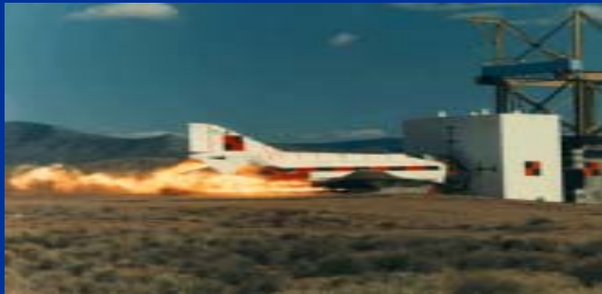
Simulation expérimentale du crash d'un avion sans une infrastructure en béton
